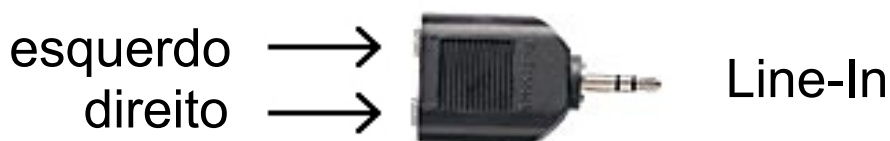
Figura 4.4. Conector usado para ligar dois microfones à placa de som.
