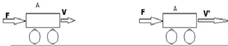
Figura 1.5: O carrinho A altera a sua velocidade de  $V$  para  $V'$  devido a ação da força  $F$  sobre o mesmo.
