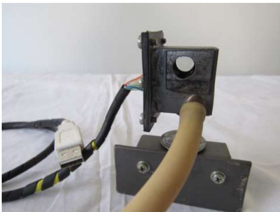
Figura 9. Célula de Ar, com seringa para vácuo e mangueira de borracha.
