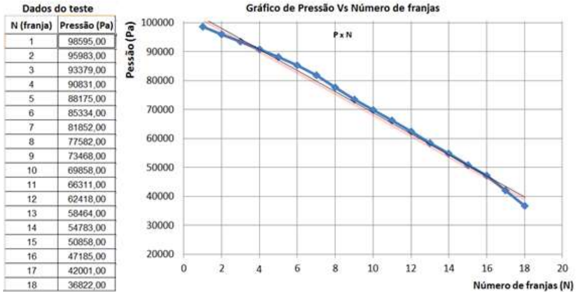
Figura 11. Dados e Gráfico do teste do índice de refração em função da pressão.
