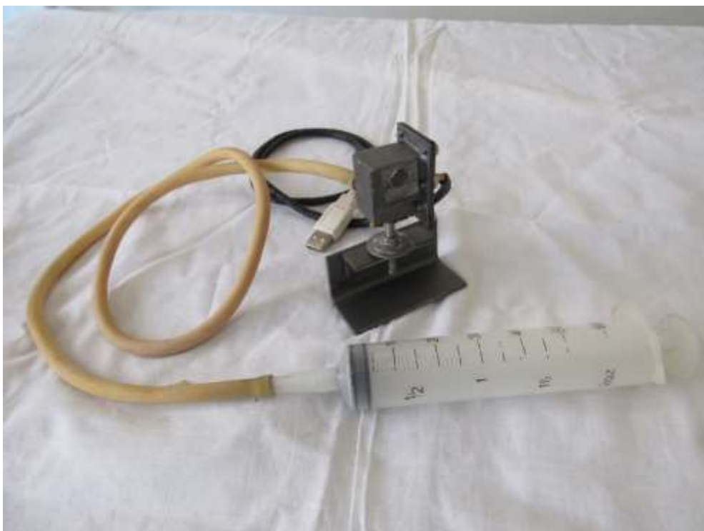
Figura 10. Célula de Ar, destaque para a janela óptica feita com lâmina de microscópio.
