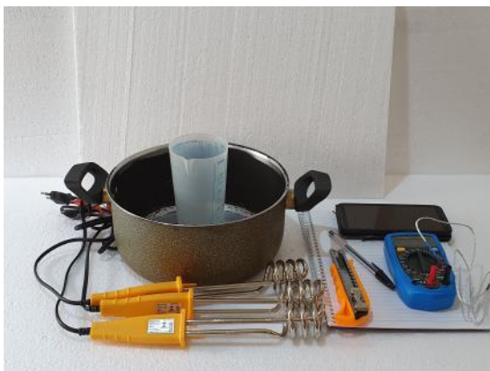
Figura 1. – Materiais empregados nas atividades: panela de metal; placas de isopor; cortador de isopor; três ebulidores; termômetro digital; e lápis e papel.
