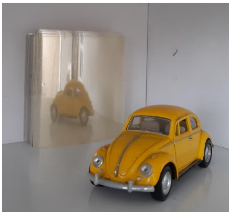
Figura 10: Refletividade de uma pilha de placa paralelas. Resultado que se aproxima de um espelho.
